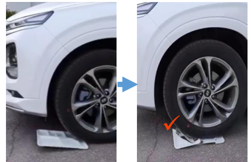
[三聚氰胺食物托盘在车辆装载后完全开裂]
