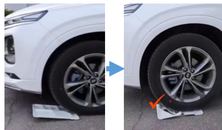
[三聚氰胺餐盘车辆加载后完全破裂]
